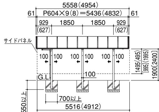
土間コンクリート施工の場合の基礎寸法
